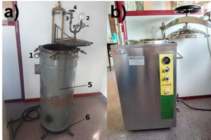
**Figura 6.** Autoclaves tipo Chamberland verticales con calefacción a gas **(a)** o eléctrica **(b)**. Partes: 1) mariposas o charnelas, 2) manómetro, 3) espita, 4) válvulas de seguridad, 5) paredes dobles, 6) fuente de calor. Nota. Imágenes tomadas por Dr. Gabriel Salinas Ibáñez. Licencia CC-BY-SA 4.0.
